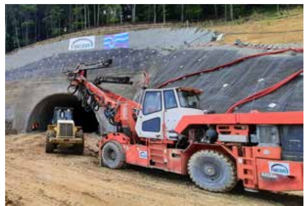
Obr. 6 Vítací voz Tamrock Axera
